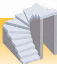
Točité dvojramenné schodisko
